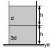
Şekildeki d ve 3d özkütleli sıvıların yere göre toplam potansiyel enerjisi  $\mathcal{E}$ , kap tabanına yapılan toplam sıvı basıncı P dir.
