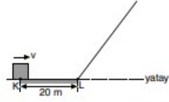
Yalnızca K-L arasının sürtünmeli olduğu bir ortamda K noktasından v hızı ile atılan cisim dönüşte K noktasında duruyor.
