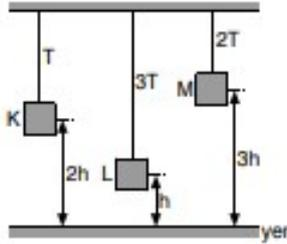
Şekildeki K, L, M cisimlerinin bağlı olduğu ip gerilme kuvvetleri sırayla T, 3T ve 2T dir.
