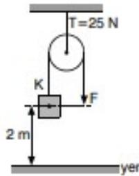
Şekildeki sistemde ip gerilme kuvveti 25 N makaranın ağırlığı 5 N dur.
