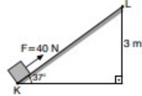
Sürtünme kuvvetinin 5 N olduğu ortamda şekildeki kuvvet cismi K den L ye kadar hareket ettiriyor.
